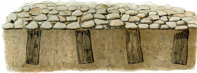
Gjennemsnit med de under Kampesteensmuren staaende Egeplanker Vest for Skandsen N o 14.
