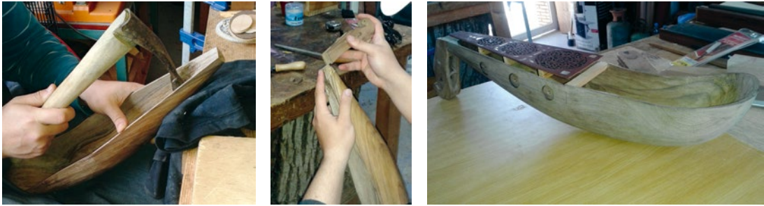
Abb. 15–17 Aushöhlen des Korpus mit einer Dechsel; Anpassen des Wirbelkastens; Instrumentenkörper mit darauf liegendem oberem Deckenteil mit drei Rosetten (Fotos: A. Chiki 2015).
