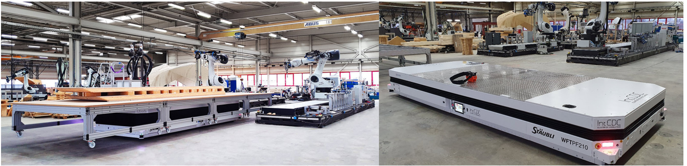
Bild 1. Cyber-physische Roboter-Vorfertigungsplattformen (links). Zu sehen ist auch das bestehende FTF (fahrerloses Transportfahrzeug) im beladenen (links) und unbeladenen Zustand (rechts). Foto: IntCDC
